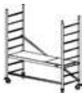
Art nr 910110 Wys. robocza: 3,0m Wys. ruszt.: 2,3m Wys. do pom.: 0,9m
